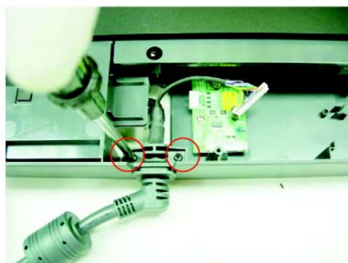
Выкрутите 2 крепежных винта (M3 x 1)
