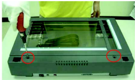
Выкрутите 2 крепежных винта (M4 x 0,7)
