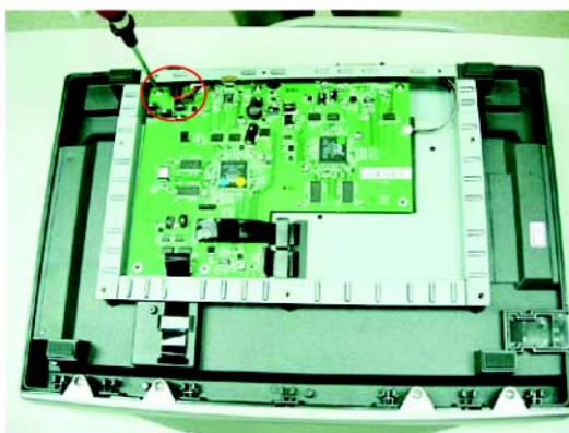
Выкрутите крепежный винт (M3 x 0,5)
