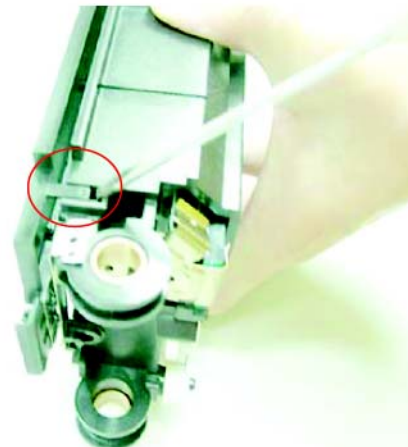
Отсоедините фиксаторы с обеих сторон крышки лампы
