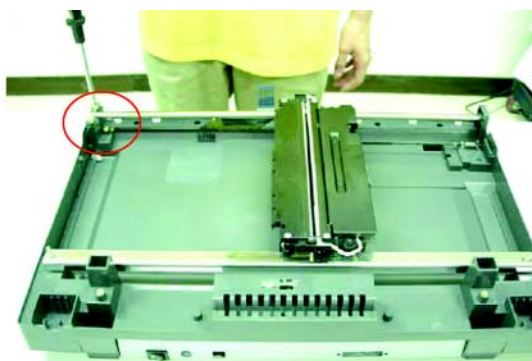
Выкрутите крепежный винт (M3 x 0,5)
