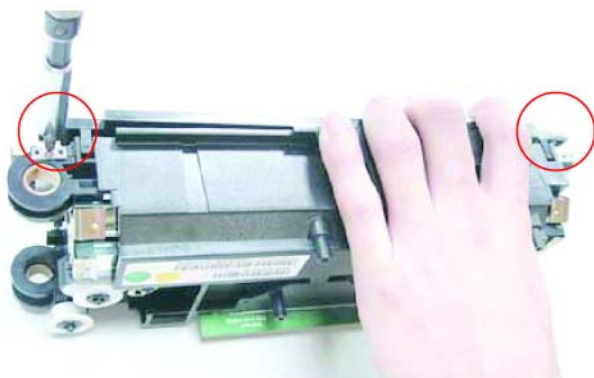
Выкрутите крепежные винты (M2 x 0,2)
