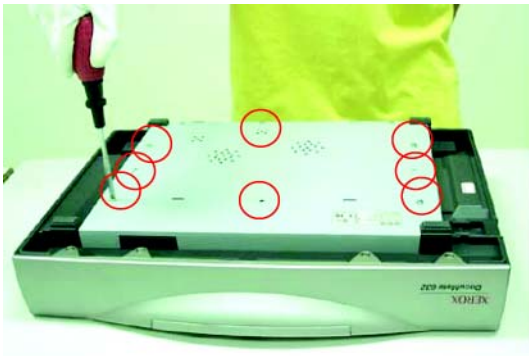
Выкрутите 8 крепежных винтов (M4 x 0,7)
