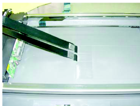
Отсоедините плоский кабель на нижней части корпуса
