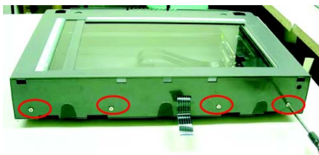
Выкрутите 4 крепежных винта (M4 x 1,5)
