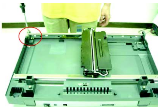
Выкрутите крепежный винт (M3 x 0,5)
