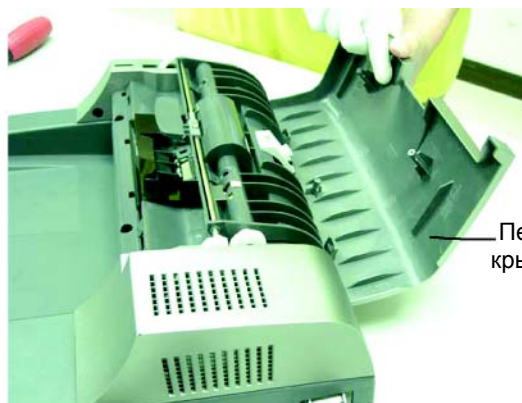
Снимите переднюю крышку ADF.
