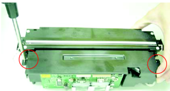
Выкрутите 2 крепежных винта (M3 x 0,2)
