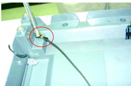
Выкрутите крепежный винт (M3 x 0,5)
