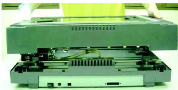
Поднимите верхнюю часть корпуса
