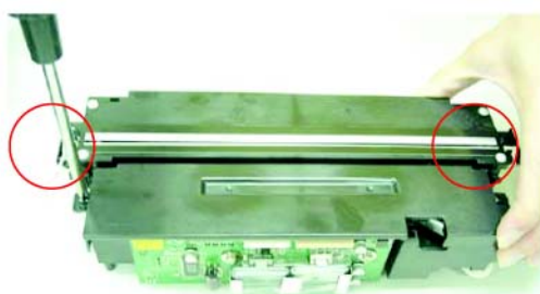
Выкрутите крепежные винты (M2 x 0,2)
