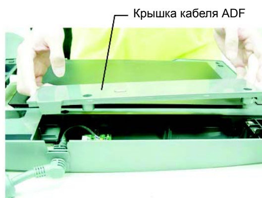
Снимите крышку кабеля ADF
