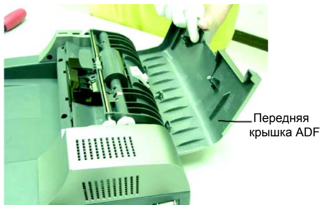
Снимите переднюю крышку ADF.
