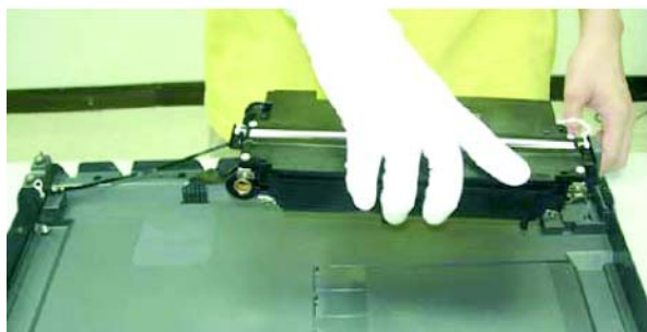
Поверните оптическое шасси
