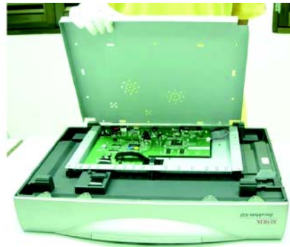
Снимите металлическую крышку
