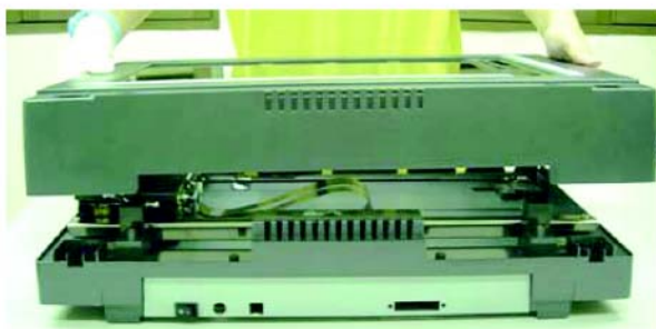
Поднимите верхнюю часть корпуса
