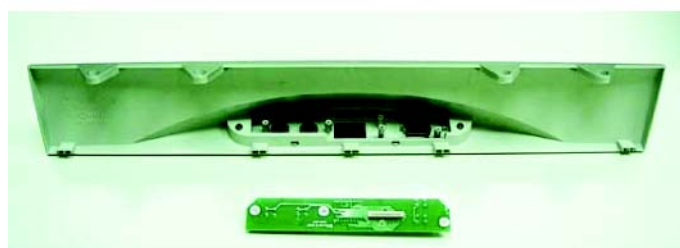
Панель кнопок и плата
