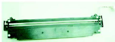
Оптическое шасси
