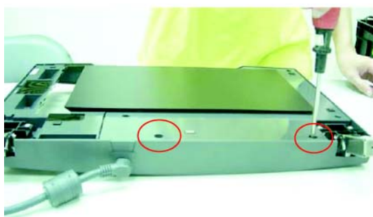
Выкрутите 2 крепежных винта (M4 x 1,27)
